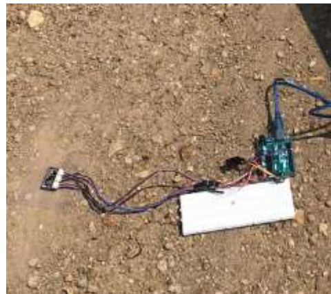
Gambar 8. Sensor Accelerometer di Tanggul Lapindo Kondisi Steady State
